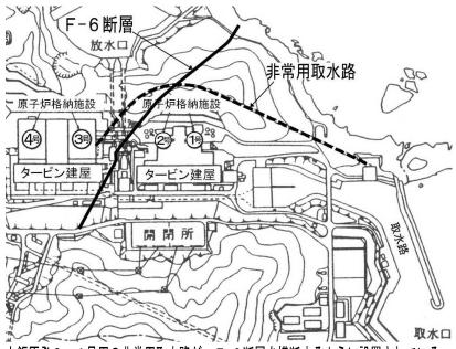
大飯原発3・4号用の非常用取水路が、F-6断層を横断するように設置されている 大飯発電所原子炉設置変更許可申請書(1989年4月)
