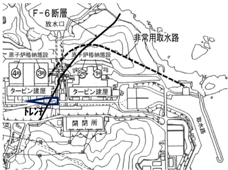
**図1. F-6断層を横切る耐震Sクラスの非常用取水路（3・4号用）** 大飯発電所設置変更許可申請書(1985.2) 添付書類6第1.1.1図にF-6断層等を加筆
