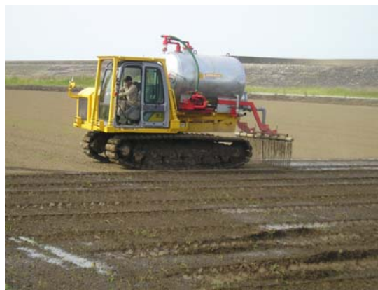
左：有機液肥製造施設＝成熟槽（好気性消化）の上部 右：液状堆肥散布用クローラーによる圃場への田植え前散布
