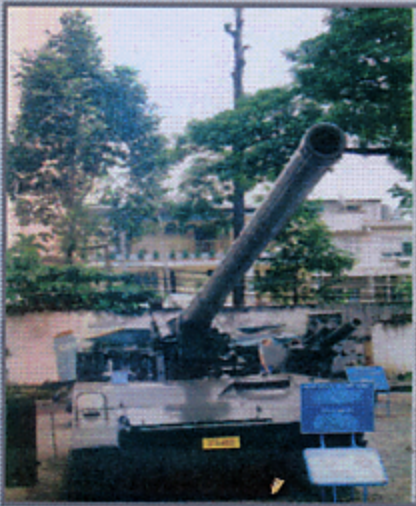
Đại bác 175mm "Vua chiến trường" (Nặng 28 tấn) Mỹ đưa loại súng này vào miền Nam Việt Nam năm 1968. Đại bác 175mm có tên khác là pháo cực nhanh, được đặt trên xe xích cơ động. Đầu đạn có tầm bắn xa từ 28km đến 30km.
