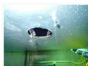
東京電力柏崎刈羽原発7号機で、蒸気を水に戻した海水が流れる配管で見つかった直径6センチの穴（東京電力提供）
