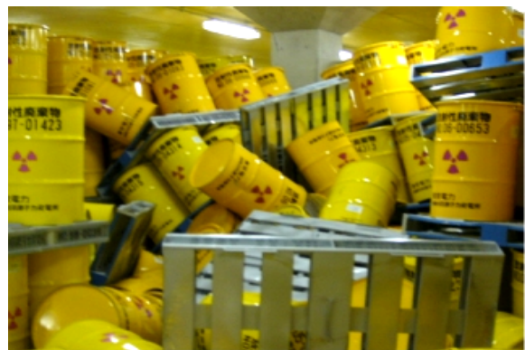
地震後の原発構内－放射性廃棄物の入ったドラム缶が倒れ、散乱。
