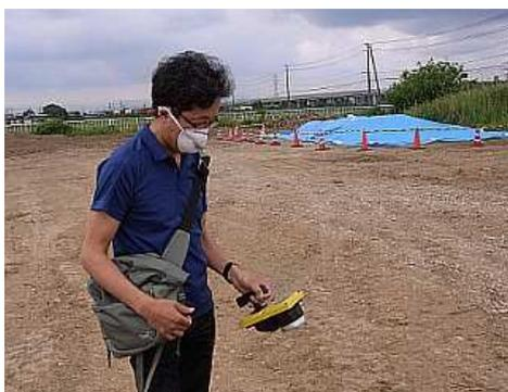
水道局では、1週間に1度、継続的に汚泥仮置き場周辺および周囲環境の空間線量率を測定しているが、これまで管理区域と周囲の空間線量は大きな差が無いとの事だった。しかし、持参したサーベイメータを用い、管理区域外から腕を伸ばしてブルーシ
