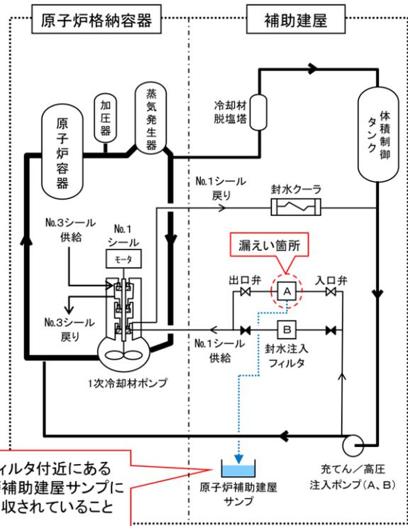
A-封水注入フィルタ付近にある目皿から原子炉補助建屋サンプに約7m<sup>3</sup>の水が回収されていることを確認
