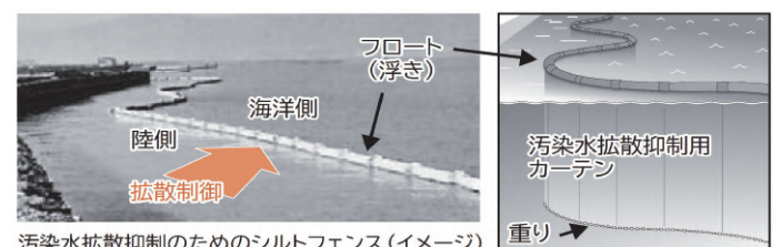
汚染水拡散抑制のためのシルトフェンス(イメージ)
