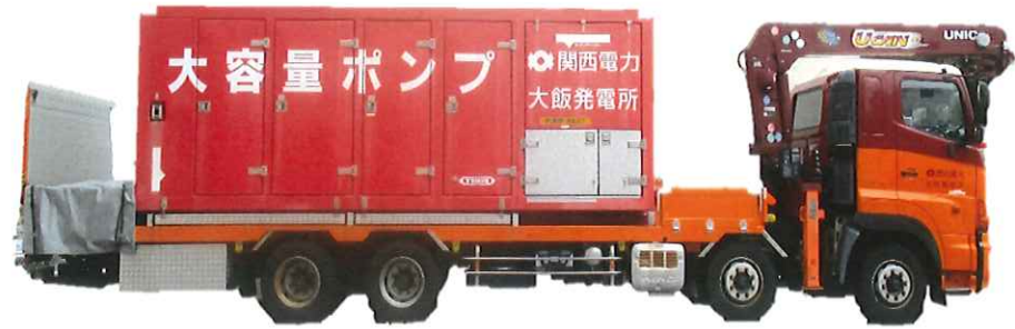
【図表1 大容量ポンプ（放水砲用）】
