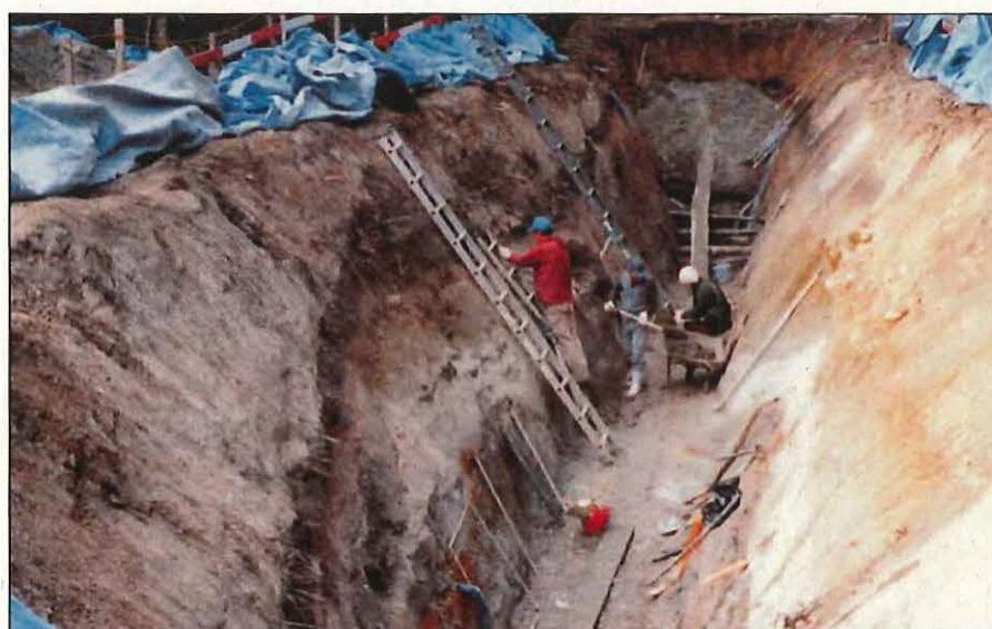
活断層のトレンチ調査の様子(猿投山断層帯)
