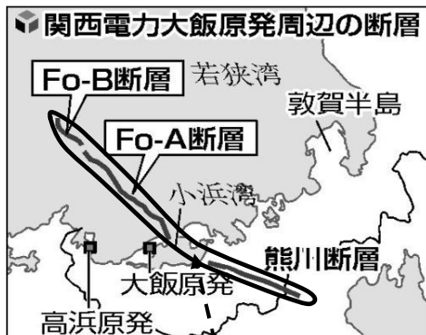
関電は、海底にある2本の活断層（Fo-B断層とFo-A断層）による約35kmの連動は評価しているが、内陸の熊川断層も含めた60km以上の連動を否定している (2012年1月28日付 読売新聞の図に加筆)
