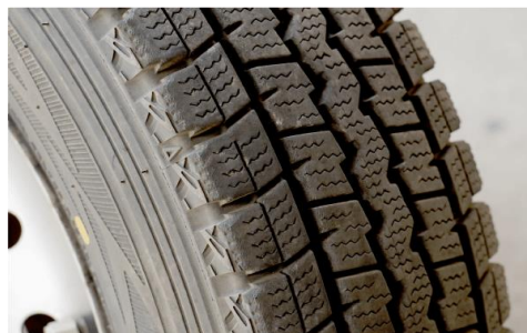
冬用タイヤ(接地面に細かく深い溝がある)
