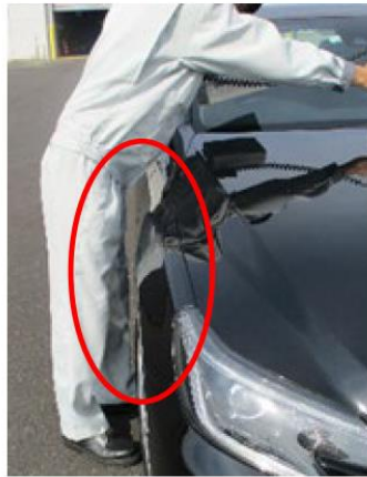
図 2.1.2-1 適切な作業姿勢の例 (車両接触なし)
