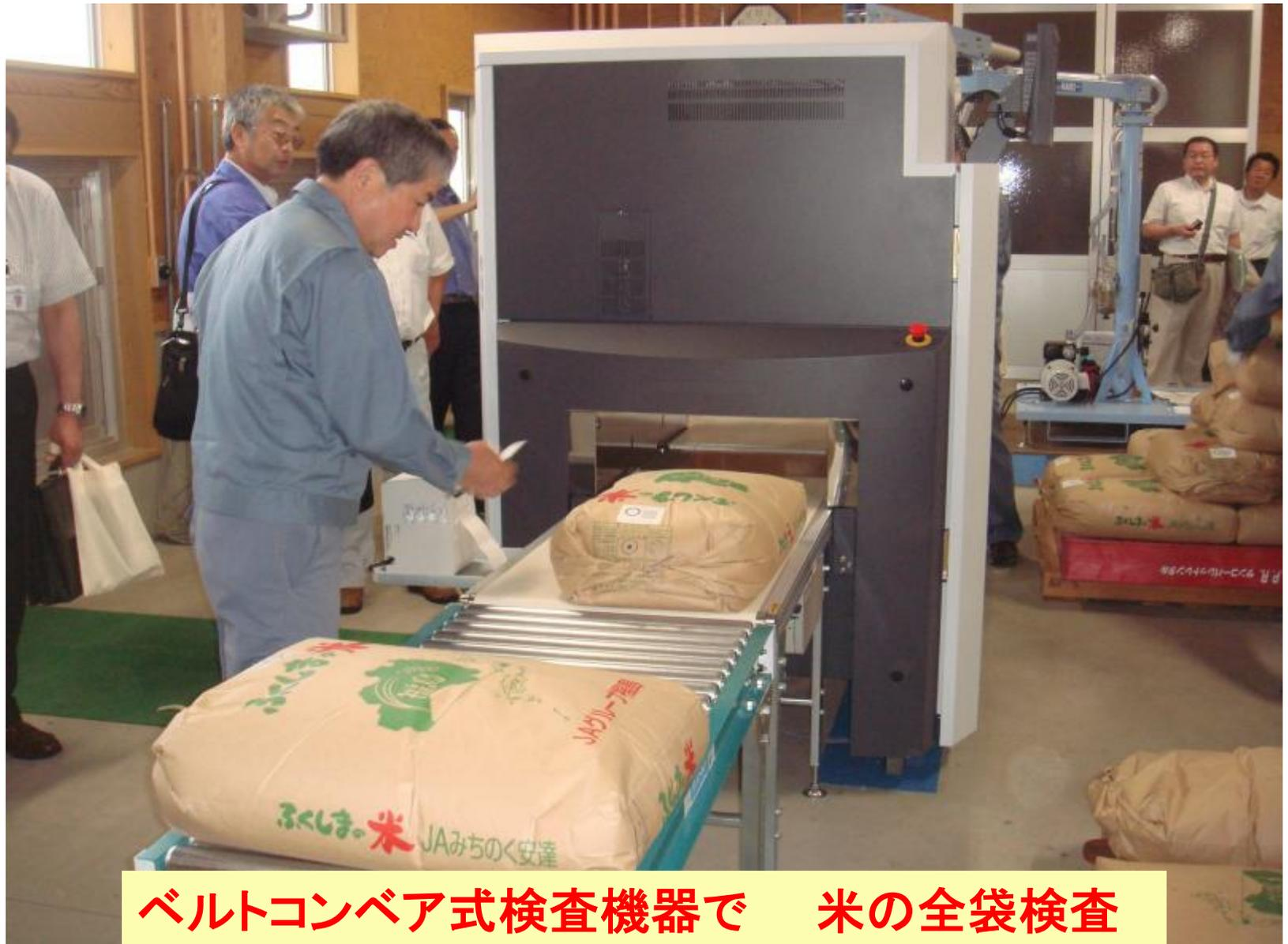
ベルトコンベア式検査機器で 米の全袋検査
