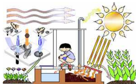
エコサン・トイレの仕組み
