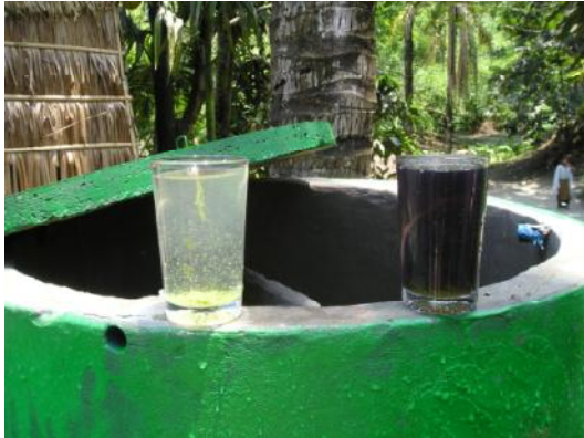
写真-5(1) 砂ろ過装置
