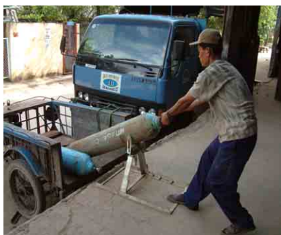
写真1: ガスボンベを器具のローラ部まで持ち上げ引っ張り上げます。
